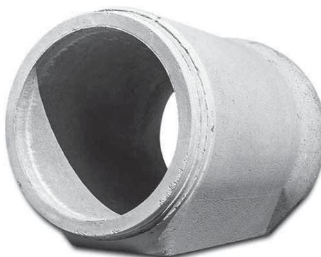
Tubazioni prefabbricate vibro-compresse a sezione interna circolare con incastro a bicchiere e spessore incrementato, conformi alla norma UNI EN 1916 e idonee al convogliamento delle acque di fognatura, meteoriche e superficiali, fibro-rinforzati o armati, con o senza base piana, su richiesta KN specifico.
